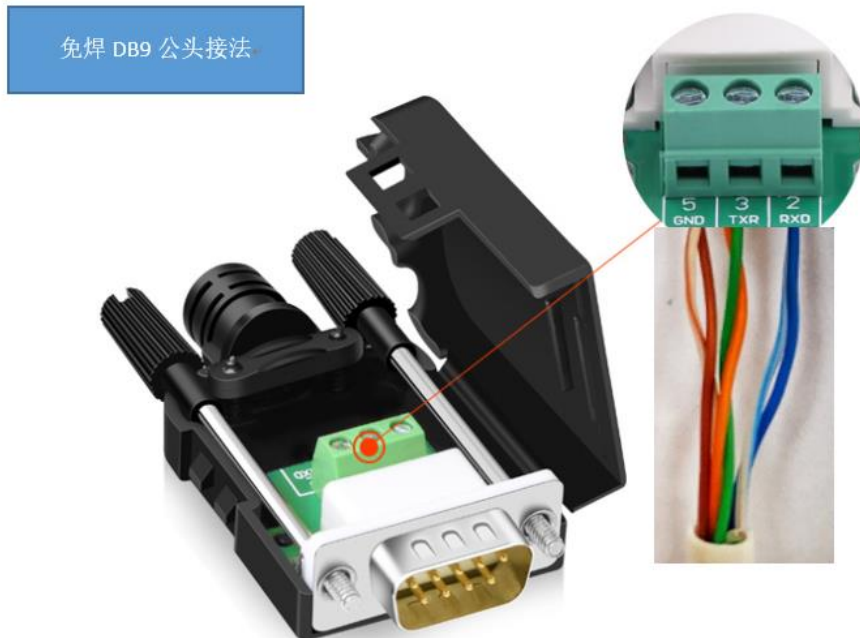
RS232 直连线(2.免焊法)
